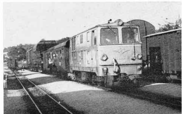
Type 2095 er standard-strækningslokomotivet ved ÖBB's 760 mm-baner. Her er 2095 12 under rangering i Alt Nagelberg, 29. august 1978.
