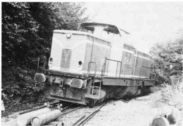
Diesellokomotivet OHJ 46 afsporede som følge af et skinnebrud i Gislinge den 26. juli 1979. Foto: A. E. Kurland.
