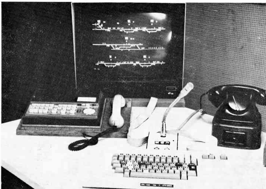
LJs nye udstyr til betjening af det elektroniske fjernstyringssystem. Farvebilledskærmen er anbragt bagved togradioen og mikrofonen til perronhøjtalerne. Tastaturet kan flyttes rundt efter betjeningspersonale's individuelle ønsker.
