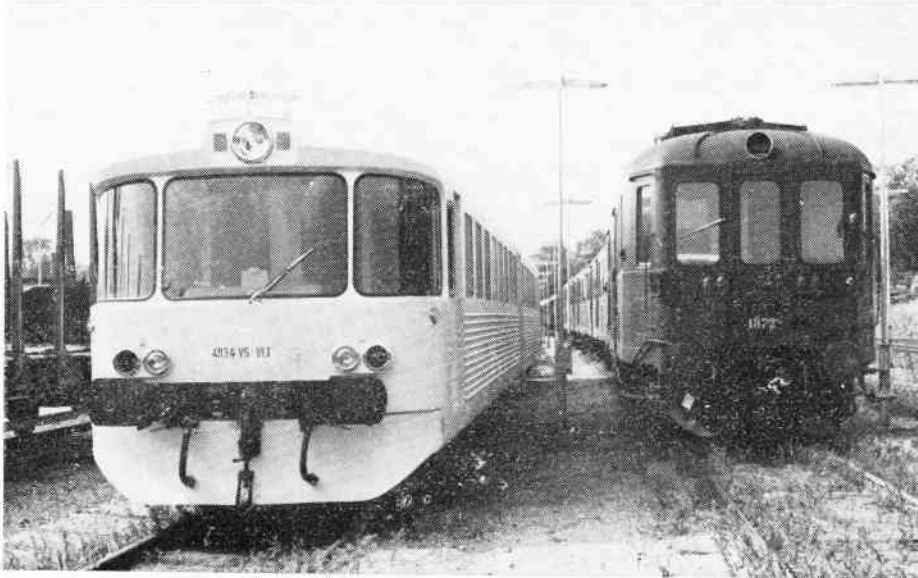
På Randers station mødes »rå« lynetogsæt til VLTJ og MO-vogne på vej til ophugning i Bjerringbro. Under transporten til Scandia er kun frontruderne monteret på lynetterne. Foto: Jan Forslund
