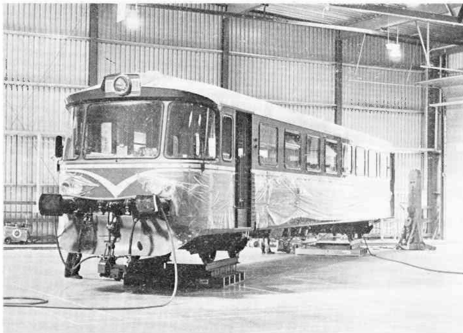
VNJ Ys 81 bliver vendt ved hjælp af luftpudeplatforme under monteringsarbejdet den 31. august 1983. Stregerne på gulvet er synlige tegn på, at hallerne bruges til firmasport udenfor arbejdstiden. Foto: Ole-Chr. M. Plum
