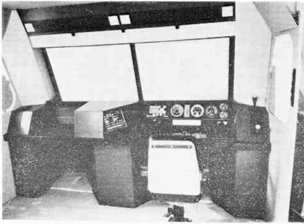
Forstudiet til indretning af førerrummet på EA-lokomotivet var baseret på de erfaringer man havde opnået med ME-lokomotivet. Modellen blev opbygget i et kælderrum i Generaldirektoratet i februar 1983.
