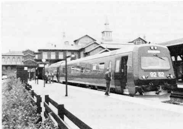
Under transporten fra Dueweg til Norge udstilles et af NSBs nye motorvognssæt, type 92, på Østerport station den 10. september 1982. Togsættene, der er beregnet til fremførsel med 140 km/h på strækninger med relativt trafikunderlag, anvender drejestrømsmeknik, og begge motorvognens bogier har asynkrone banemotorer. Foto: Asger Bergh
