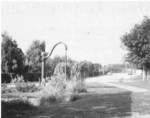
Engang kørte togene fra Grindsted til Varde her. Da stationen blev ombygget, benyttede man lejligheden til at indrette et lille anlæg i VaGJs tidligere drejeskive-grube, og den gamle vandkran fik et nyt sted at stå. Nu løber den hele sommeren, og vandet havner efter en dekorativ tur ned ad en kæde i drejeskive-gruben, hvor mere eller mindre eksotiske planter kæmper med betonen om overmagten... Foto: Anders Riis
