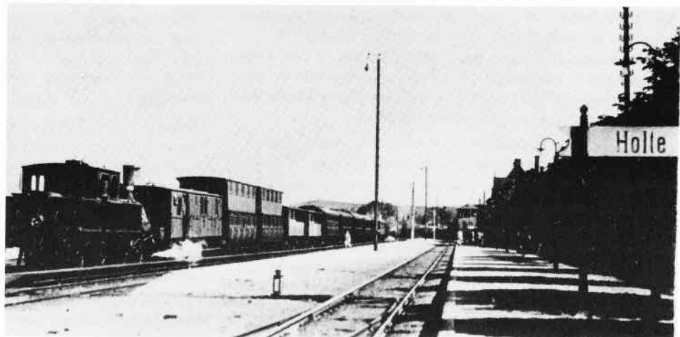
Holte station en gang til, en sommermorgen vistnok i 1923. Ikke for at vise forandringerne på stationen, men på grund af toget, som en O-maskine er parat til at føre mod København. I det indgår både dobbeltdækkere, åbne skovvogne (med de ikke oprindelige skydevinduer anbragt forrest i kørselsretningen) og rystevogne. Læseren vil selv vide at vælge det tillægsord, som bedst dækker hans opfattelse af oprangeringen, men her er foreløbig nogle forslag: grotesk, utrolig, genial, grinagtig, malerisk, pinlig, økonomisk, umenneskelig, Storm P-agtig, grænseoverskridende! Foto: P. Rutherford, arkiv: Jernbanemuseet
