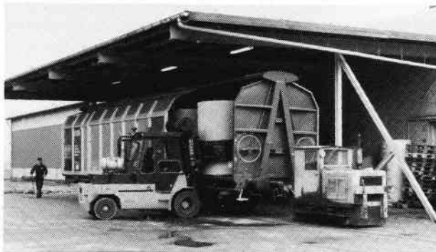
En dværg og en kæmpe mødes. Højbygård Papirfabriks smalsporede Pedershaab-tractor rangerer lystigt videre med normalsporsvogne på treskinnesporet. Her har den lille grønne truffet sin modsætning, en vogn, der er lige så lang som sit litra: DSB Hbbllns. John Hansen fotograferede i Holeby 30. marts 1988.
