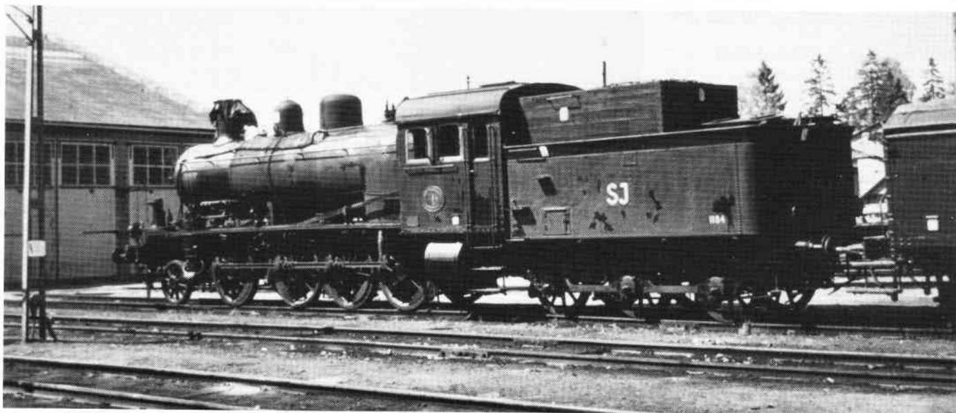
E2-maskinerne blev ved ombygningen fra E til E2 forlænget en meter til den ekstra forløber. E2 1184 i Åmål, 27. maj 1968. Foto: Hans Jørn Fredberg.
